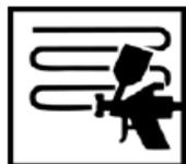
Aplicar sobre as superfícies desengraxados com Solução Desoleante 05.00.00400. Aplicar 2 a 3 passadas cruzadas com intervalo de 5 a 10 minutos entre passadas. Camada de no máximo 10 a 12µm
