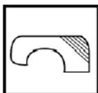
Limpar adequadamente a superfície a ser pintada, removendo partes soltas, ferrugem, oleosidades e resíduos impregnantes, com Solução Desoleante 400. Ler as instruções no verso da embalagem, antes de utilizar o produto. Aplicar o Wash Primer 045 para proteger as áreas expostas onde atingiu a chapa
